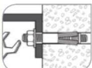
Posicione a peça a fixar, recoloque o parafuso e arruela dando o devido aperto.
