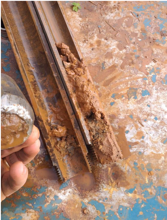
Foto- 1 AMOSTRA DA SONDAGEM SP01
